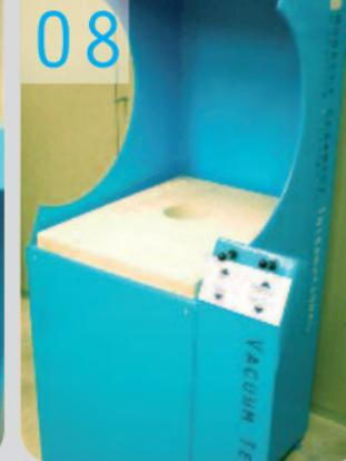
PORTARE IL LIVELLO VUOTO DA 0 BAR (FIG.1) A -0,4 BAR (FIG.3) TRAMITE LA LEVA PRESSIONE VUOTO (FIG.2)
